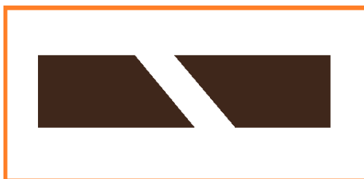
Rys. 10. Czołowe łączenie listew wykończeniowych.
